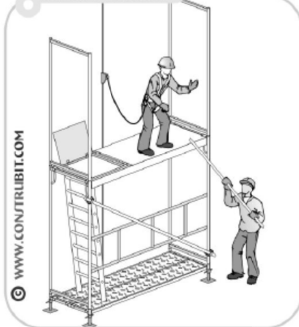
armado de andamio
