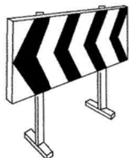
VALLA DE DESVIAMIENTO DE TRAFICO
